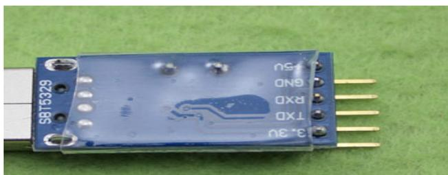
上图是 usb 转串口模块，三根线和板子相连就可以了，GND 接板子的 GND，TX 接板子的 RX，RX 接板子的 TX；
